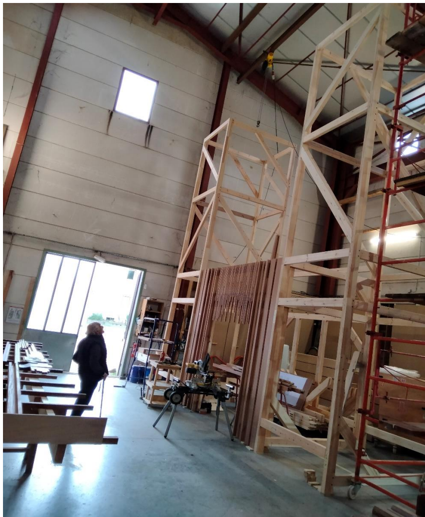
Les deux colonnes centrales de la charpente du buffet dans l'atelier de Pascal Quirin.
